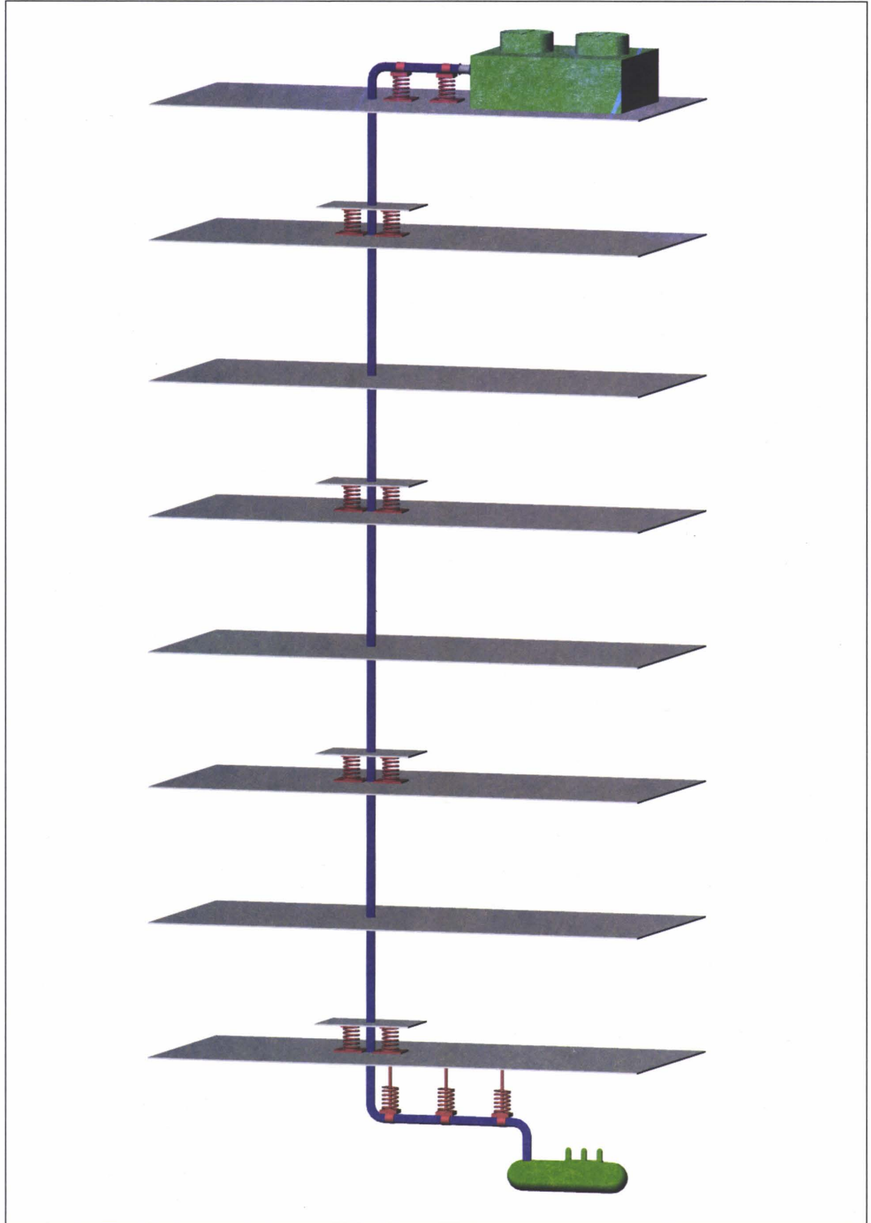
Şekil 12.64. KOLON BORULARINDA ISIL BOYUT DEĞİŞTİRMELERE VE TİTREŞİME KARŞI YÜZER SİSTEM KULLANIMI
