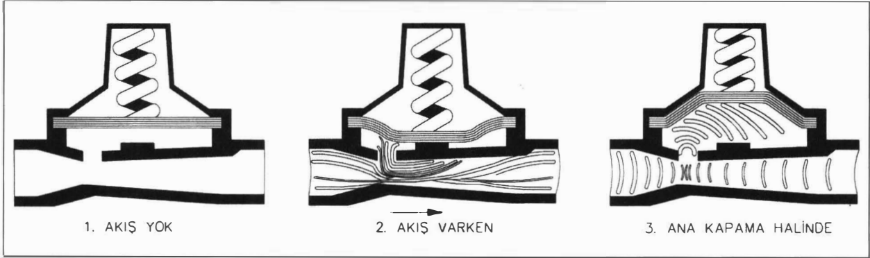
Şekil 5.24 / ŞOK ABSORBERLERİN ÇALIŞMA PRENSİBİ
